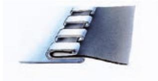
Detalle engatillado tipo LOC-4
