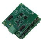
Pasarelas de aerotermia
