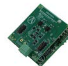
Pasarelas de aerotermia
